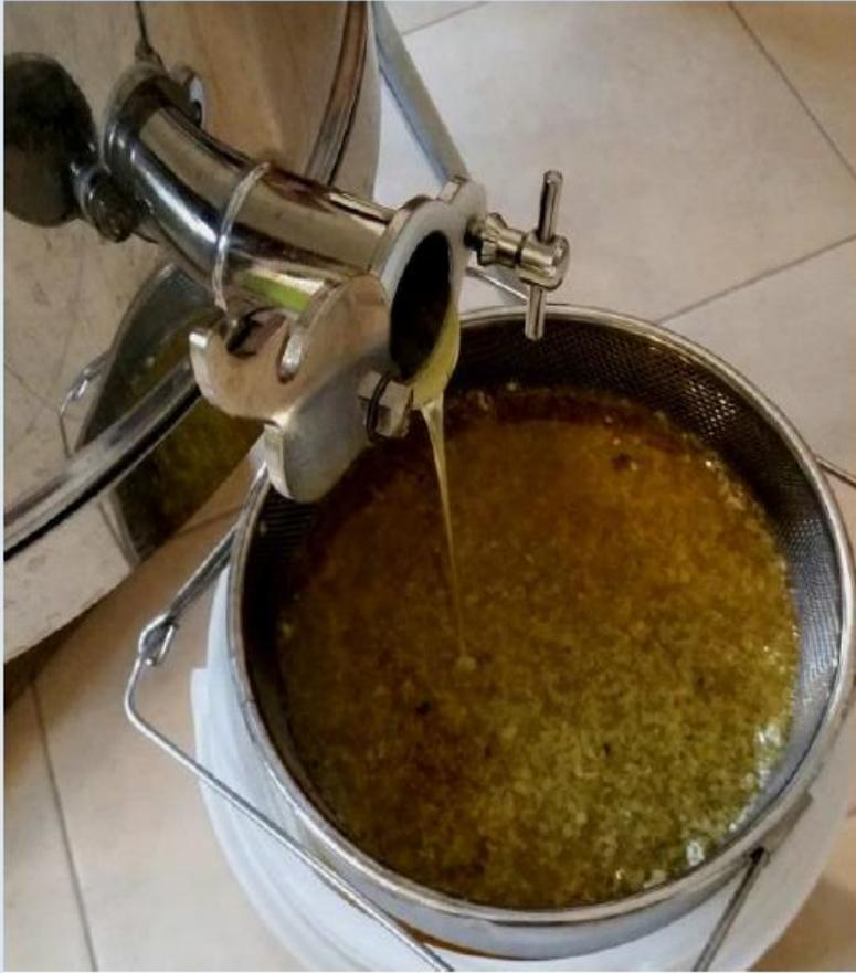
Mit einem Sieb werden die groben Partikeln aus dem Honig entfernt
